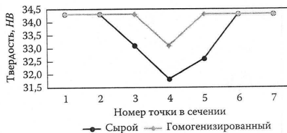
Рис. 5. Распределение твердости ( НВ ) в сечении цилиндрического слитка из сплава 6063 в исходном состоянии и после гомогенизации по скорректированному режиму
