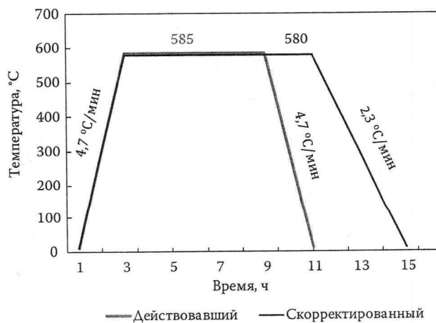
Рис. 4. Действовавший и скорректированный режимы гомогенизации цилиндрических слитков
